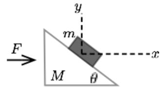
*Solución:* Hay dos cuerpos: el bloque  $m$  y el plano inclinado  $M$ . Vamos a elegir el suelo como marco de referencia inercial, puesto que el plano inclinado se mueve de forma acelerada. La aceleración del plano es  $\vec{a} = a\hat{x}$ . Si queremos que el bloque no se mueva respecto al plano, este debe llevar también la misma aceleración,  $a$ . Seleccionamos el marco de referencia como en la figura. Las fuerzas en el bloque  $m$  son:
